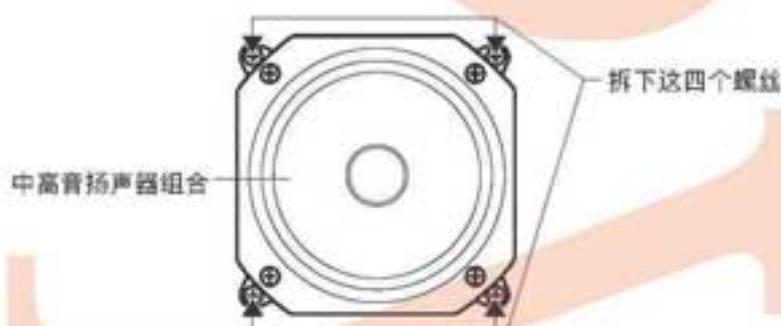
3. 将每个黑色底座上的中高音扬声器组合转动180度，音响组合将大幅度地靠向外侧，然后将卸下的螺丝拧上。
