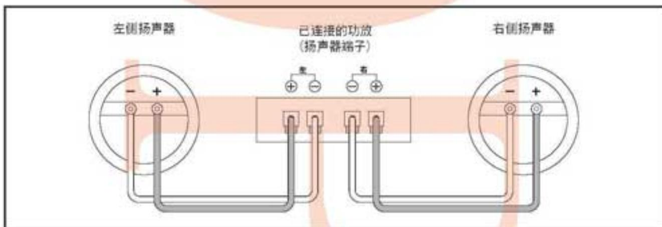
\* 如果左右扬声器的极性连接不正确，则再现音质、环境气氛和方向感将受到明显的影响。
